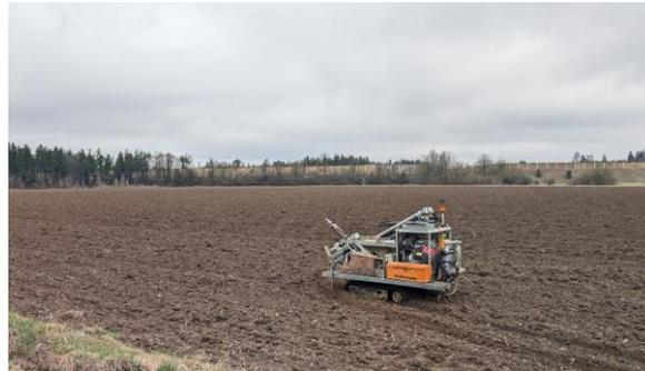
**Foto 1:** Blick auf das Baufeld: Die Erkundungsarbeiten wurden mit einer ferngesteuerten Sondierraupe Typ "ARGOS" durchgeführt. Der hydraulische Hammer bringt 111 Joule auf die Sonden.
